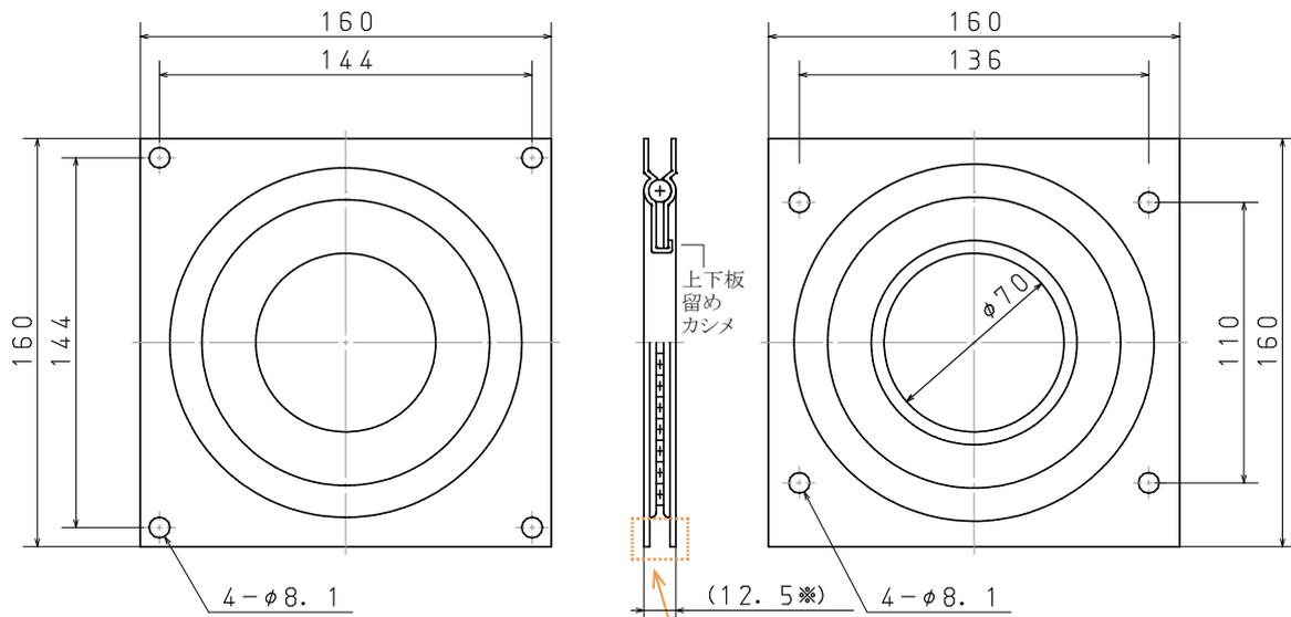
※ 高さ12.5mmの特に四方端部箇所は、プレス工程上ならびに材料の伸縮等から ダレや反りによる波形状等が発生します。表記寸法12.5より約±1.5mm以上のバラツキとなりますので、大変申し訳ありませんが、当該箇所は現物寸法を優先とさせていただきます。
